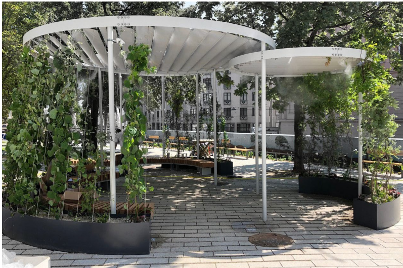
Cool-Spot als Kombination von Rankpflanzen, technischer Verschattung und Nebелеlementen (Tröpferl-Bad in Wien)
