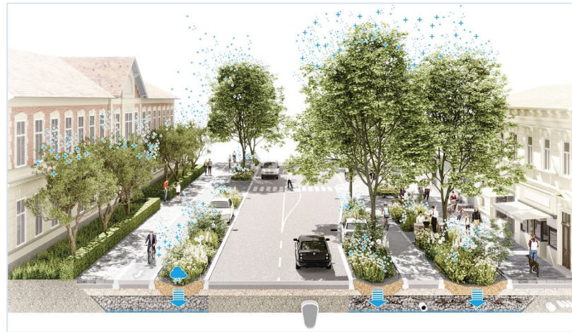
Versickerungsbeete und Baumrigolen als Speicher
